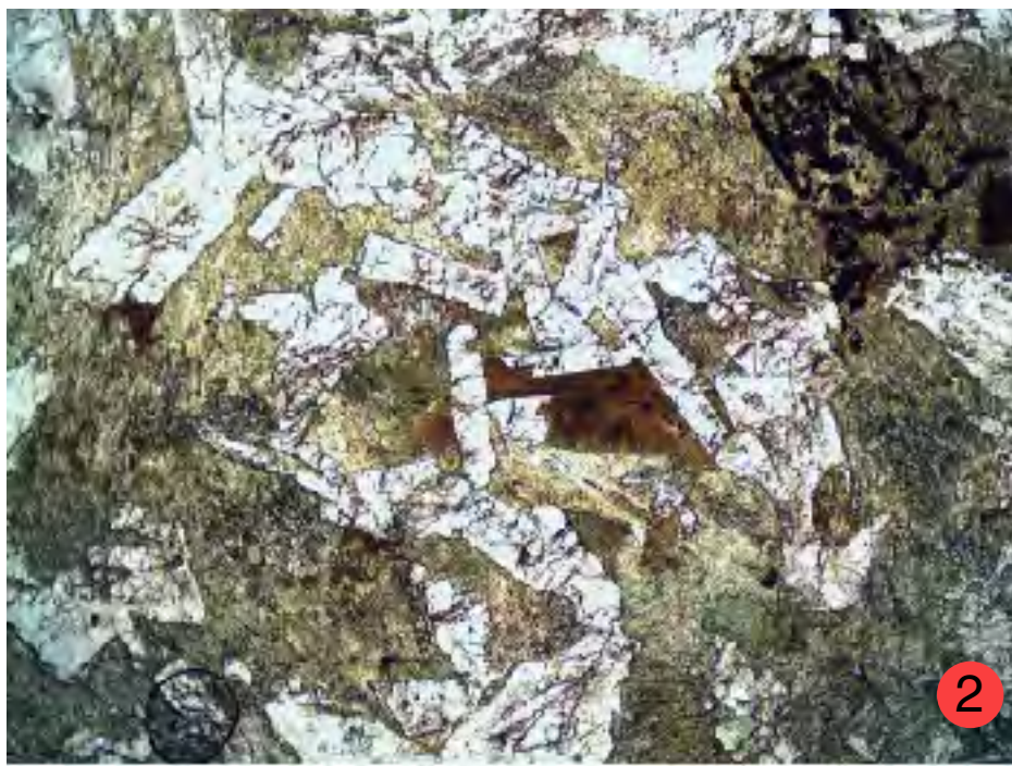
Parfois, le clinopyroxène a disparu et la roche est une amphibolite. La texture ophitique de la roche est préservée.
